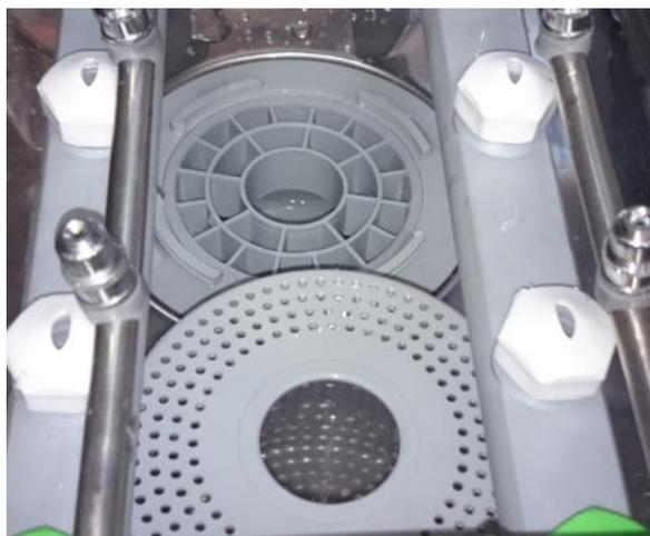
Entnehmen Sie den Ansaugfilter und ggf. reinigen Sie diesen wenn erforderlich. Wascharmee mit einer leichten Links-Drehung und leichtem Ziehen aus der Bajonethalterung entnehmen.
